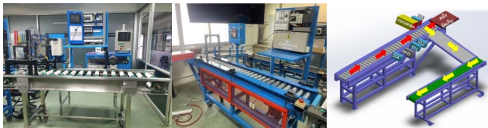
ภาพที่ 3 ชุดทดลองการประยุกต์ใช้เทคโนโลยีคลื่นความถี่วิทยุในการระบุผลิตภัณฑ์
